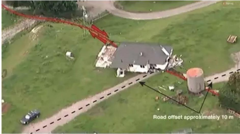
图 8. Kekerengu 断层破裂早曾的房屋损坏 (来源: GNS)
